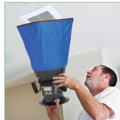
Utilisation d'un balomètre aux fins de vérification du rendement installé
