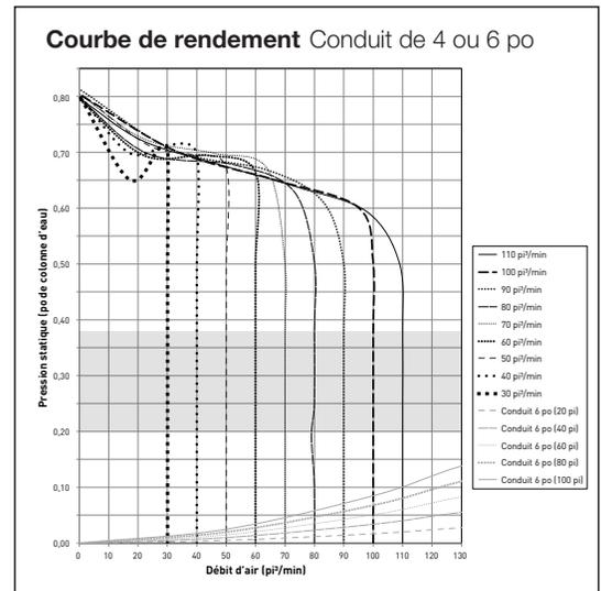
\*Les recherches dans le secteur indiquent que la pression statique dans les installations typiques varie de 0,20 à 0,375 po de colonne d'eau.
